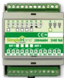
Módulo SimpleHome con cinco entradas digitales optoaisladas y cuatro salidas de relé de 16 A en guía DIN (514016A)
